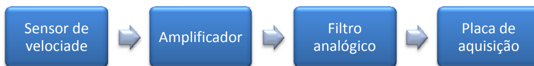
Figura 31 - Fluxograma dos equipamentos utilizados para a medição da velocidade de queda do identador.
