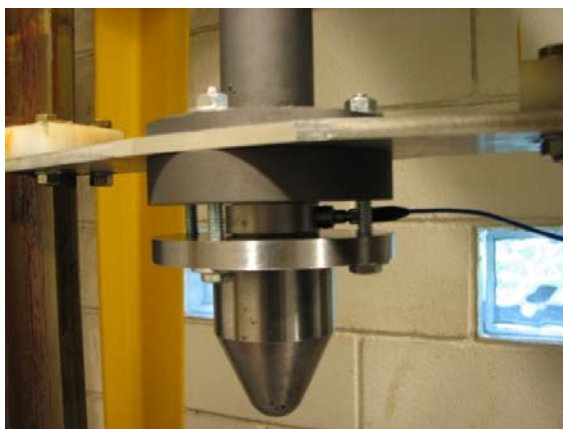
Figura 32 - Célula de carga PCB 200C02 fixada junto ao equipamento de ensaio de queda de peso.
