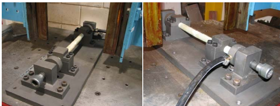
Figura 21 - Base para a fixação e pressurização de tubos pronta para a realização de ensaios.
