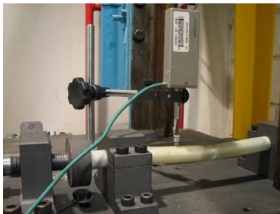
Figura 34 - Sensor de posição apalpador LE-25.
