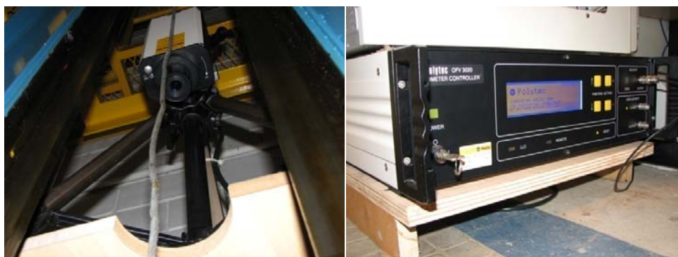
Figura 25 - Sensor de velocidade a laser Polytec OFV-323, à direita, e controlador OFV3020, à esquerda.
