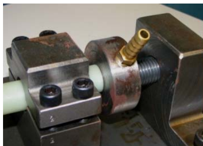
Figura 20 – Espigão instalado na base para fixação e pressurização de tubos.
