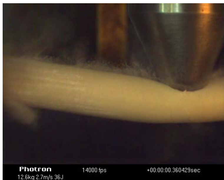
Figura 52 – Observação dos locais de vazamento de fluido durante o impacto.
