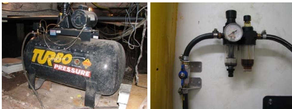
Figura 24 - Compressor volumétrico de ar utilizado para os ensaios e sistema de regulação de pressão.
